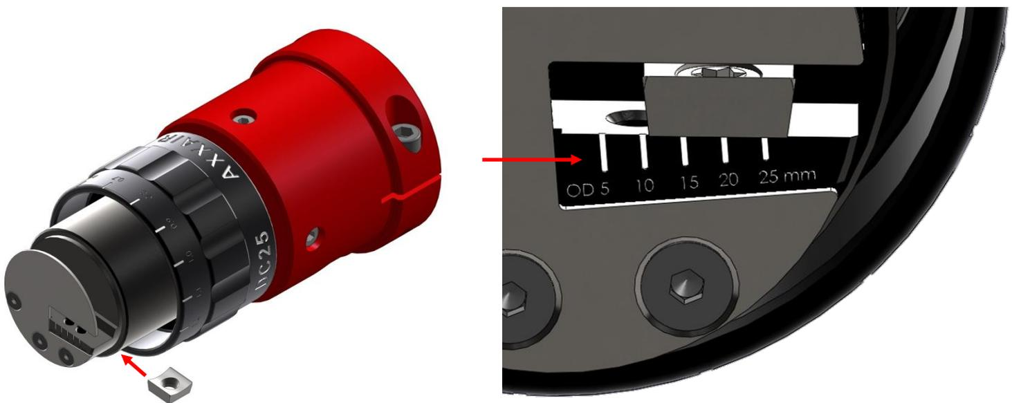
Después, coloque y apriete el tornillo plaqueta (par de apriete = 2,55 Nm, destornillador Torx T15 suministrado).
