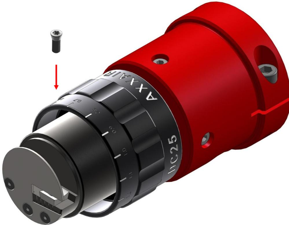
Infine riposizionare la parte anteriore della DC25 facendo attenzione ad allineare la coppiglia con l'apposita scanalatura.
