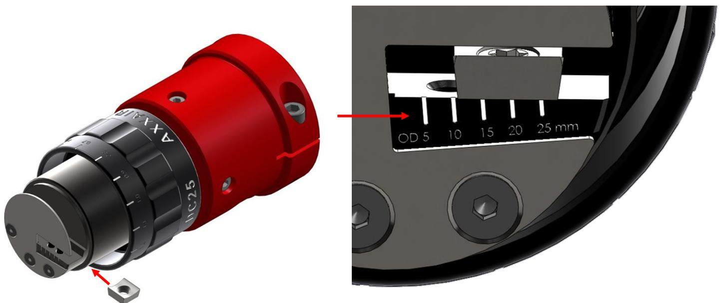
Dann die Schneidplattenschraube einsetzen und festdrehen (Anzugsmoment = 2.55 Nm, T15 Torx-Schraubenschlüssel wird mitgeliefert).
