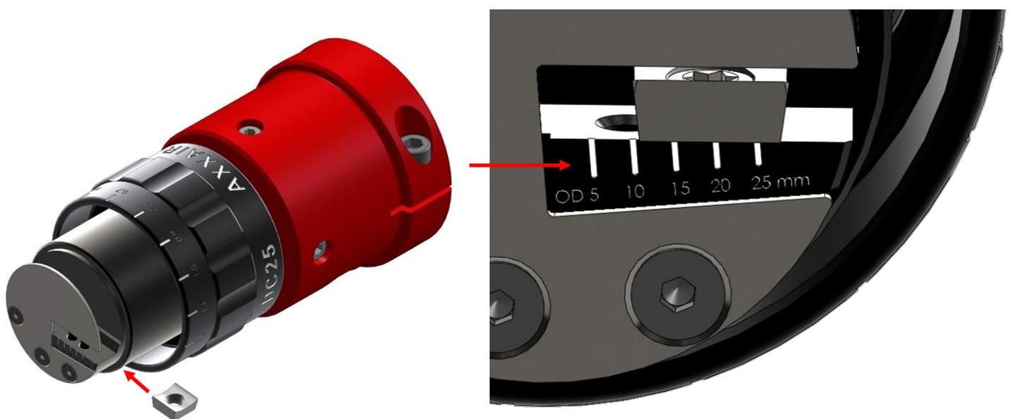
Poi posizionare e serrare la vite targhetta (coppia di serraggio = 2,55 Nm, cacciavite Torx T15 fornito)
